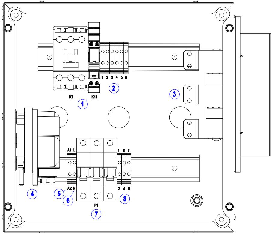
Фигура 4 – блок питания - тип 1x18kW
