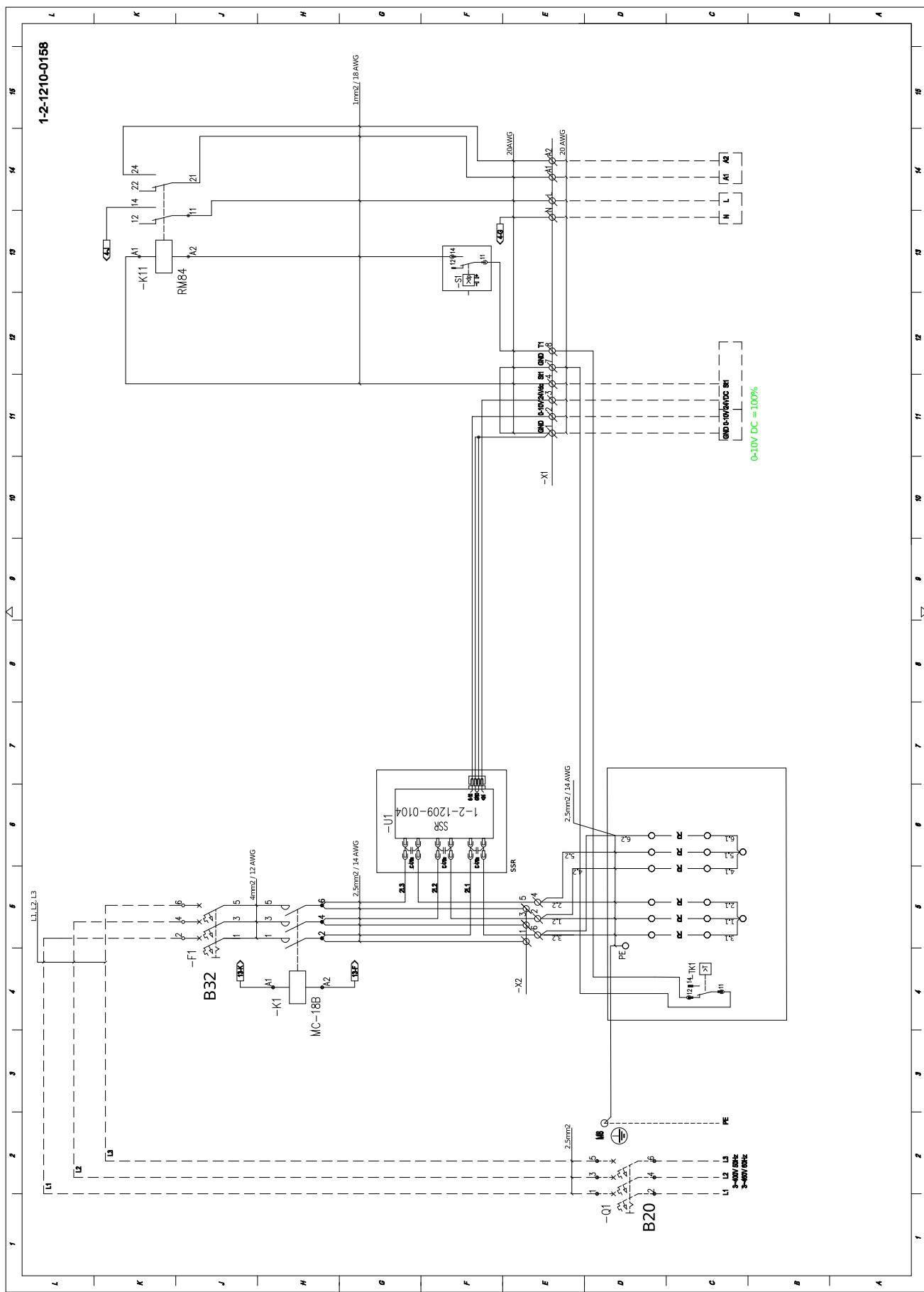
пунктирной линией обозначены соединения, выполненные пользователем, сплошной линией - соединения, выполненные производителем
